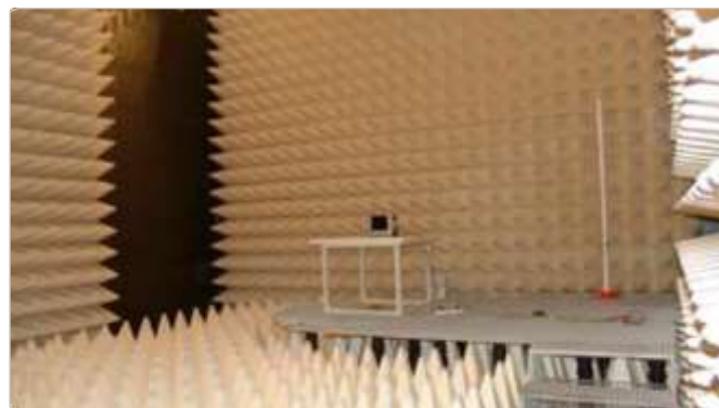
Полностью безэховая камера с помостом
