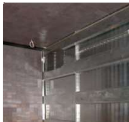
Структура монтажа ферритовых поглотителей
