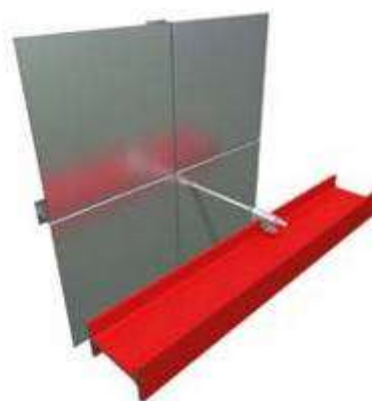
Пример крепления стенки
